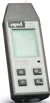
Le radiamètre **FH 40 GL-10** est conçu pour les mesures d'équivalent de dose et de débit d'équivalent de dose ambiant  $H^*(10)$  des rayonnements gamma et X. Simple d'utilisation et performant, il est utilisé par de nombreux acteurs de la radioprotection. Une large gamme de sondes externes connectables en fait l'appareil polyvalent de référence.
