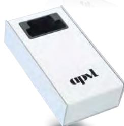
Les bornes **ACT-4** et **ACT-5** sont des bornes de table dédiées à la lecture des dosimètres EPD Mk2 et EPD N2. Elles fonctionnent avec l'interface BORNEO, conçue par APVL (cf. Interface BORNEO p. 6 du catalogue). Ces deux bornes sont adaptées aux services ayant peu d'utilisateurs dont l'identification se fait par un clavier intégré sur la borne (**ACT-4**) ou par le clavier du PC (**ACT-5**).
