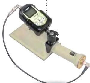
La **GP13A** est une sonde de haute sensibilité qui mesure l'irradiation X, gamma et la contamination bêta, avec un détecteur à scintillation CsI d'une surface de 100 cm<sup>2</sup>. Elle se connecte au RadEye SX qui possède une voie unique bêta, gamma et X.
