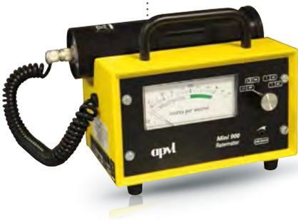
Le **Mini 900** est un contrôleur d'irradiation et de contamination, portable ou fixe, décliné en plusieurs versions. Équipé d'une large échelle logarithmique, il indique les niveaux de bruit de fond et affiche de fortes valeurs d'irradiation ou de contamination sans changer d'échelle. Le **Mini 900** fonctionne sur batterie ou sur secteur.
