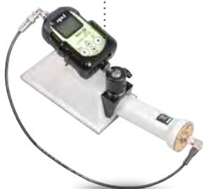
Les sondes **DP6** et **BP19** d'une surface de 100 cm<sup>2</sup> sont compatibles avec le RadEye SX et peuvent ainsi former un ensemble mural sur secteur pour le contrôle du personnel (mains, vêtements). L'ensemble peut aussi être décroché pour des mesures au sein du service. La sonde **DP6** contrôle et détecte la contamination des particules alpha, bêta et gamma lorsque la sonde **BP19** est adaptée au contrôle bêta et gamma.
