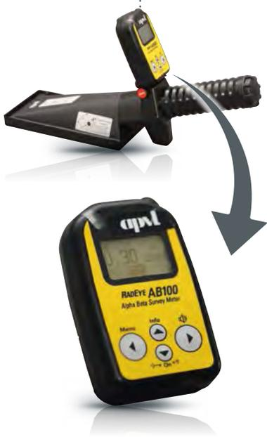
Le **RadEye AB100** est un contaminamètre surfacique doté d'une excellente discrimination alpha / bêta d'une surface de 100 cm<sup>2</sup>. Compact et très léger, il est utilisable d'une seule main. Facilement paramétrable, les mesures peuvent être affichées en Bq ou Bq/cm<sup>2</sup>. Le logiciel en option permet de régler le RadEye et la haute tension de la sonde.
