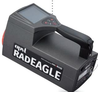
Le **RADEAGLE** est un spectromètre conçu pour la détection, la mesure et l'identification des sources de rayonnement gamma. En option, il est capable de détecter des sources neutron. Il est proposé avec trois types de détecteurs au choix qui ne requièrent aucune source externe de calibration : NaI(Tl), CeBr<sub>3</sub> et LaBr<sub>3</sub>.
