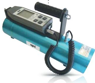
Ce système complet, composé du radiamètre FH 40 GL-10 et de la sonde FHZ 672 E-10, utilise la technologie **NBR** pour la mesure avec discrimination de l'irradiation naturelle et artificielle.
