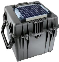
Balise permettant la mesure du débit de dose neutron jusqu'à 100 nSv/h en H\*(10). Energie de 25 meV à 5 GeV. Elle fonctionne dans une plage de température allant de -30°C à +50°C. Entièrement autonome, elle communique avec le logiciel NMC par différentes options (LTE/GPRS).
