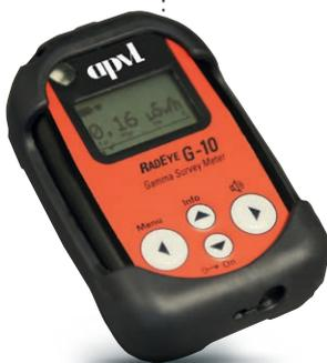
Les **RadEye** versions **G-10** et **GF-10** sont des radiamètres robustes, destinés aux mesures d'équivalent de dose et de débit d'équivalent de dose  $H^*(10)$  des rayonnements gamma. Ils disposent d'une large gamme d'énergie allant de 45 keV à 3 MeV. Ils sont paramétrables et adaptables à l'utilisateur.
