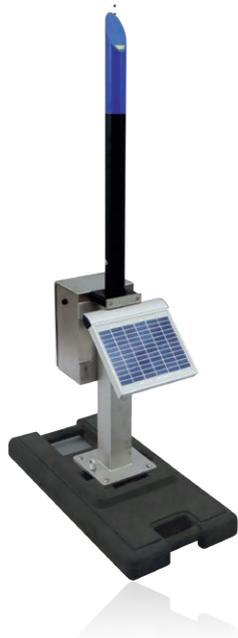
Balise permettant la mesure du débit de dose gamma de 10 nSv/h à 10 Sv/h en H\*(10) à distance et en continu. Elle fonctionne dans une plage de température allant de -40°C à +60°C avec une protection IP68 / IP65. Entièrement autonome, elle communique avec le logiciel NMC par différentes options (LAN, GPRS, LTE, RADIO, RS485, RS232).
