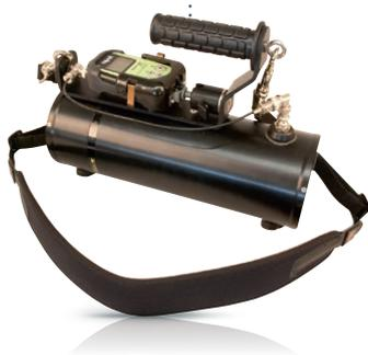
Le système RadEye NBR permet de détecter des sources radioactives cachées. Composé d'un RadEye SX fixé sur la sonde FHZ 674 NBR, son détecteur à scintillation de haute sensibilité mesure le débit de dose ambiant H\*(10) allant de 0,01 à 100  $\mu$ Sv/h. La technologie NBR permet la discrimination de la radioactivité naturelle et artificielle et ce, même dans un bruit de fond fluctuant.
