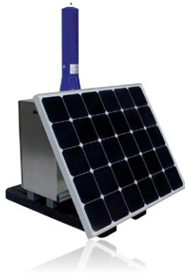
Balise permettant la mesure du débit de dose gamma jusqu'à 100 mSv/h avec analyse spectrométrique. Il est possible d'étendre la gamme de débit de dose en ajoutant un second détecteur en option. Entièrement autonome, elle communique avec le logiciel NMC par différentes options (LAN, GPRS, LTE, Radio, RS485, RS232).
