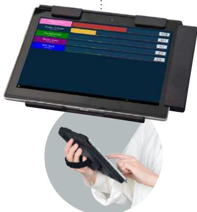
La solution est composée d'une tablette tactile et d'un logiciel de supervision. Compatible avec l'EPD Mk3 BGT, ce système affiche en temps réel l'évolution de la dose, des débits de dose et des alarmes pour la surveillance d'une équipe. Il permet la gestion et la surveillance à distance d'un parc de dosimètres afin de garantir l'optimisation des temps d'intervention et la diminution de la dosimétrie.
