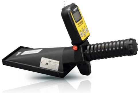
Le **RadEye AB100** est un contaminamètre surfacique doté d'une excellente discrimination alpha / bêta d'une surface de 100 cm<sup>2</sup>. Compact et très léger, il est utilisable d'une seule main. Facilement paramétrable, les mesures peuvent être affichées en Bq ou Bq/cm<sup>2</sup>. Le logiciel en option permet de régler le RadEye et la haute tension de la sonde.
