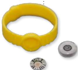
Le **dxtRAD** est un système intégré de mesures dosimétriques d'extrémités par thermoluminescence. Les bagues plastiques, à usage unique, sont très confortables et s'ajustent avec précision au diamètre du doigt. L'élément dosimétrique est indissociable de son identification, garantissant ainsi la traçabilité parfaite de l'information. L'ensemble est automatisable et utilise pour la lecture, les lecteurs manuels 4 500, 6 600 Plus et 8 800 Plus, spécialement adaptés pour cette application.
