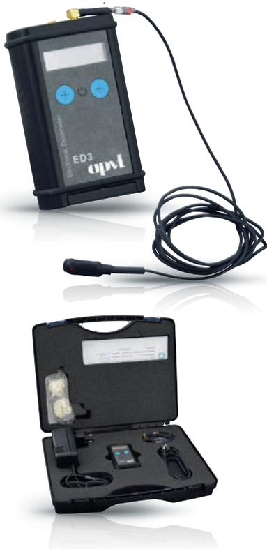
Le dosimètre **ED3** permet de mesurer et d'afficher en temps réel l'équivalent de dose individuel et son débit. Il inclut un module électronique avec afficheur, 1 à 2 sonde(s) basse ou haute énergie étalonnée(s) en Hp(0,07) pour la mesure des rayonnements bêta / gamma, des protège-doigts en caoutchouc, un chargeur, un câble USB et un logiciel.
