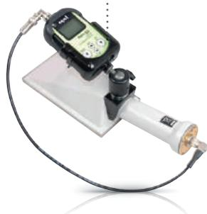
Les sondes **DP6** et **BP19** d'une surface de 100 cm<sup>2</sup> sont compatibles avec le Radeye SX et peuvent ainsi former un ensemble mural sur secteur pour le contrôle du personnel (mains, vêtements). L'ensemble peut aussi être décroché pour des mesures au sein du service.
