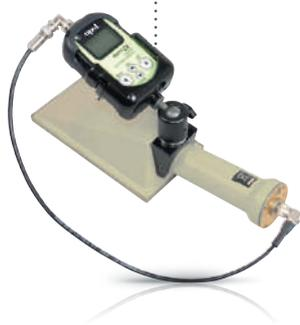
La **GP13A** est une sonde de haute sensibilité qui mesure l'irradiation X, gamma et la contamination bêta, avec un détecteur à scintillation CsI d'une surface de 100 cm<sup>2</sup>. Elle se connecte au RadEye SX qui possède une voie unique bêta, gamma et X.
