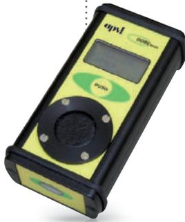
Equipé d'une chambre de mesure de très haute performance, le **Doseman** identifie par spectrométrie les particules alpha émises par le Radon. Petit, léger et antichoc, il comporte un écran LCD rétroéclairé, un clavier souple et une interface IrDA permettant de régler les paramètres et de transférer les spectres vers un PC.
