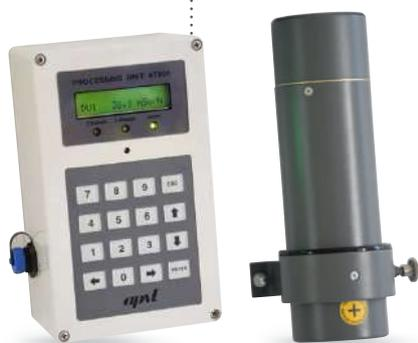
L'**AT2327** est un dispositif comprenant une unité d'affichage reliée à une sonde de mesure du débit de dose des rayonnements X et gamma. L'unité d'affichage comprend un afficheur, des voyants et un avertisseur pour prévenir en cas de dépassement d'un seuil d'alarme (2 seuils d'alarme). La sonde dispose d'une large gamme de mesure (0,05  $\mu$ Sv/h à 10 Sv/h) et d'une gamme d'énergie étendue de 20 keV à 10 MeV.
