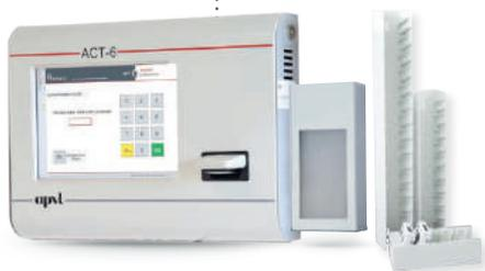
La borne **ACT-6** est une borne compacte dotée d'un écran tactile permettant l'attribution des dosimètres nominativement ainsi que la lecture des doses en sortie de zone contrôlée. Elle peut être installée sur un support bureau ou fixée au mur. Elle fonctionne avec l'interface BORNEO, conçue par APVL ingénierie. Un stockage provisoire des données dosimétriques est possible grâce à son disque dur interne (en cas de rupture de réseau informatique).
