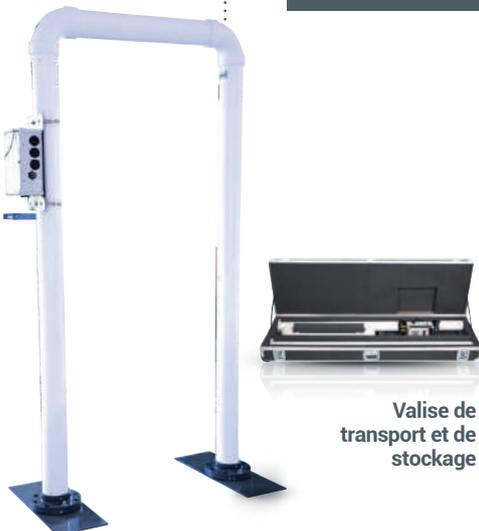
Le système **TPM-905** est un portique de détection gamma pour le contrôle automatisé de personnes et/ou de véhicules. Transportable et rapidement déployé, il dispose de deux scintillateurs plastiques de grande surface, d'un capteur de présence et d'une alarme sonore et visuelle. Le **TPM-905** peut s'utiliser localement (sur batterie ou sur secteur) ou à distance via notre système de supervision ViewPoint.
