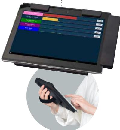
La solution est composée d'une tablette tactile et d'un logiciel de supervision. Compatible avec l'EPD Mk3 BGT, ce système affiche en temps réel l'évolution de la dose, des débits de dose et des alarmes pour la surveillance d'une équipe. Il permet la gestion et la surveillance à distance d'un parc de dosimètres afin de garantir l'optimisation des temps d'intervention et la diminution de la dosimétrie.
