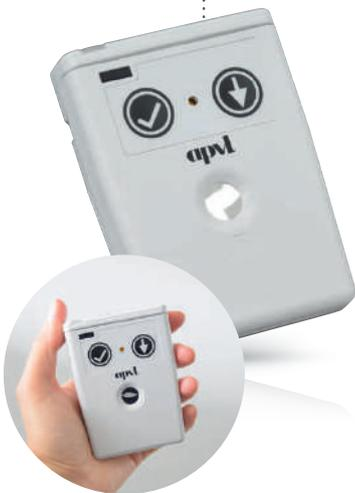
Les dosimètres **EPD Mk3 X,  $\beta$ ,  $\gamma$**  sont des dosimètres électroniques de dernière génération qui permettent la surveillance par lecture directe et en continu de l'équivalent de dose et du débit d'équivalent de dose d'une personne. Leur haute sensibilité allant jusqu'à  $0,05 \mu\text{Sv/h}$  fournit une fiabilité remarquable dans la précision d'exposition et la mesure des champs pulsés est également possible.
