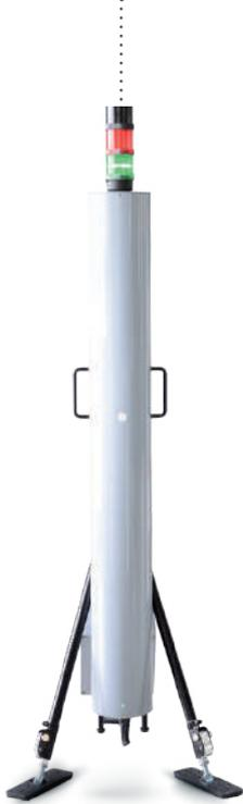
Le système **MPMS** est un portique transportable conçu pour la détection de sources radioactives. Il peut être installé sur de nombreux terrains, pour contrôler l'accès des personnes ou des véhicules et/ou intervenir sur des événements radiologiques. Grâce à ses performances radiologiques et à l'utilisation de la méthode NBR, il permet de discriminer la radioactivité d'origine naturelle de l'artificielle et d'atteindre de faibles niveaux de sensibilité.
