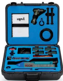
L'**AP4C-SIM** est un simulateur de détection de composés soufrés et phosphorés, arsenic et autres gaz. Il est adapté lors d'entraînements dans n'importe quel lieu, sans utiliser de simulants nuisibles à la sécurité, la santé et l'environnement.
