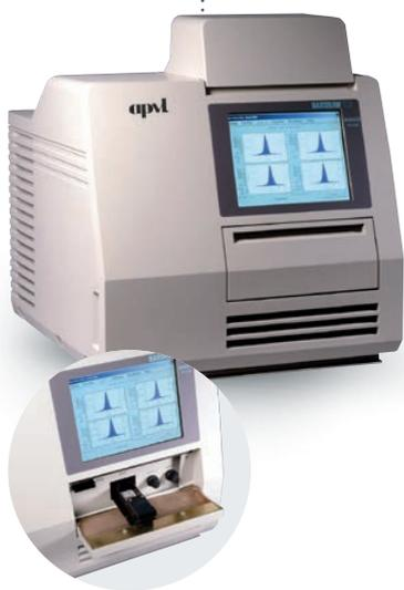
Le Modèle 6600 Plus est un système autonome de dosimétrie par thermoluminescence. Il permet la lecture automatique de 200 cartes équipées de deux à quatre dosimètres, par courant d'azote chaud (sans contact). Il permet également la lecture automatique des dosimètres extrémités extRAD et dxtRAD. Le logiciel winREMS gère les paramètres de lecture, les étalonnages, la gestion et l'archivage des résultats.
