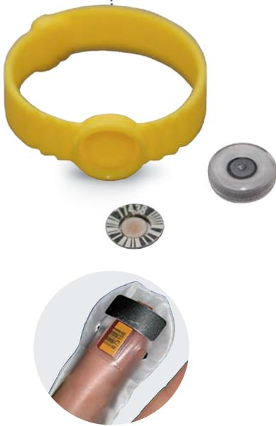
**dxtRAD** est un système intégré de mesures dosimétriques d'extrémités par thermoluminescence. Les bagues plastiques, à usage unique, sont très confortables et s'ajustent avec précision au diamètre du doigt. L'élément dosimétrique est indissociable de son identification, garantissant ainsi la traçabilité parfaite de l'information. L'ensemble est automatisable et utilise pour la lecture les Modèles 4500, 6600 et 8800, spécialement adaptés pour cette application
