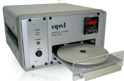
Le Modèle 2210 est un irradiateur de table au  $^{90}\text{Sr}$  permettant d'exposer automatiquement jusqu'à 50 dosimètres FLi (chips, rods ou micro-cubes). Il est utilisé localement pour effectuer des vérifications périodiques de calibration sans avoir recours aux étalons primaires.
