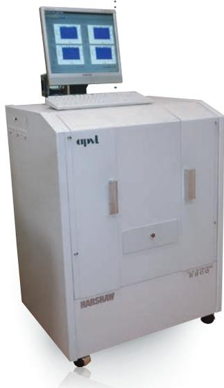
Le Modèle 8800 est un système de mesures dosimétriques par thermoluminescence. Destiné aux services de surveillance radiologique du personnel, il permet la lecture automatique de 1400 cartes équipées de deux à quatre dosimètres, par courant d'azote chaud (sans contact). Il permet également la lecture automatique des dosimètres extrémités extRAD et dxtRAD. Le logiciel winREMS gère les paramètres de lecture, les étalonnages, la gestion et l'archivage des résultats.
