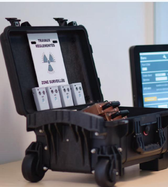
*Banc muni de 3 sources sous enceinte protégée ne nécessitant aucun zonage*
